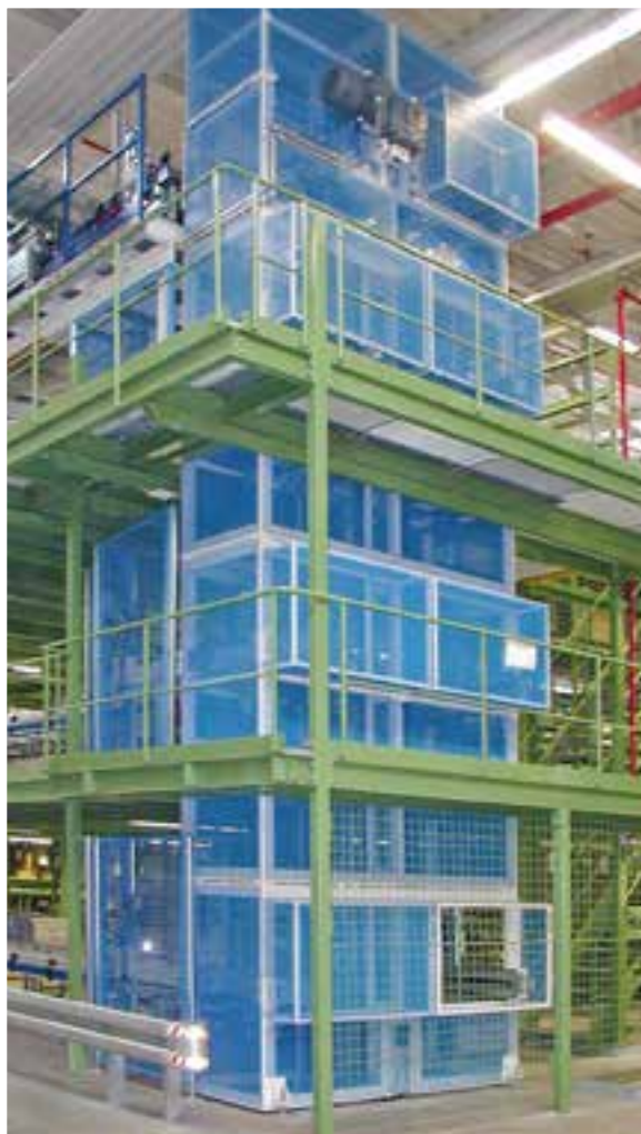
Тактовый подъемник на посыльном складе
