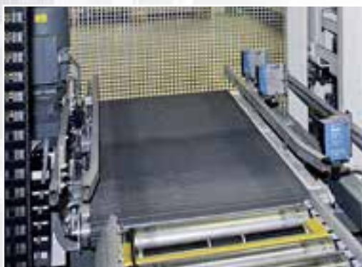
Подъемные салазки с ленточным транспортером
