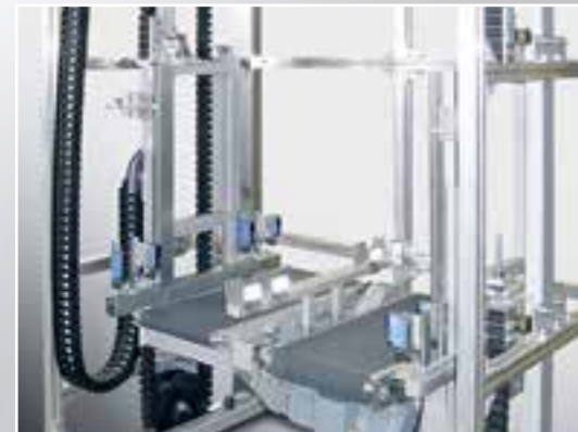
Опционально возможна установка двухстороннего ленточного транспортера
