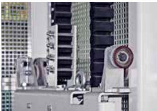
Движение консоли по вулкановым роликам
