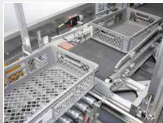
Загрузочная станция портального подъемника с передачей на наклонный подающий транспортер с одновременной сортировкой (разделением)
