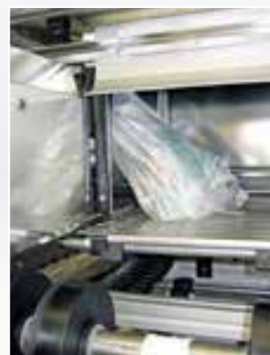
Упаковки с дефектами
